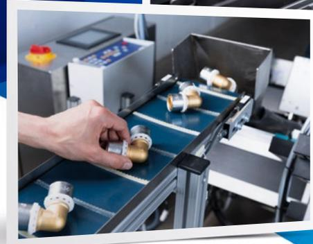
Die Produktion erfolgt mit speziellen Montagemaschinen und Halbautomaten.
